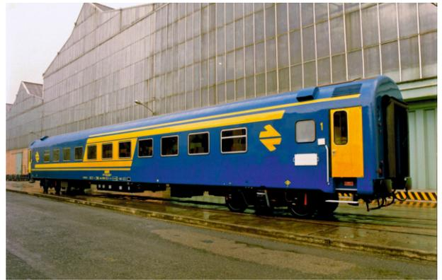
Una vez desarrollado el prototipo se comenzó a diseñar la serie que se pasaría a denominar como 9000. Las novedosas características de la misma eran la climatización, mejoras en la insonorización, una gran ergonomía y un sistema de rodadura compuesto por bogies y sistema de frenado aptos para velocidades de 160 km/h.
