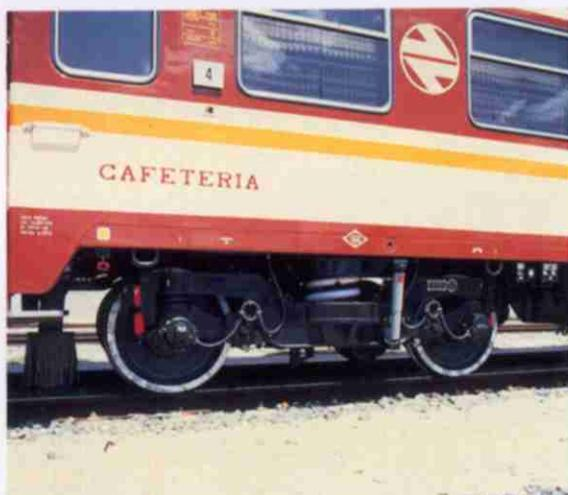
Los coches van montados sobre bogies GC3A que permiten circular a 160 km/h.
