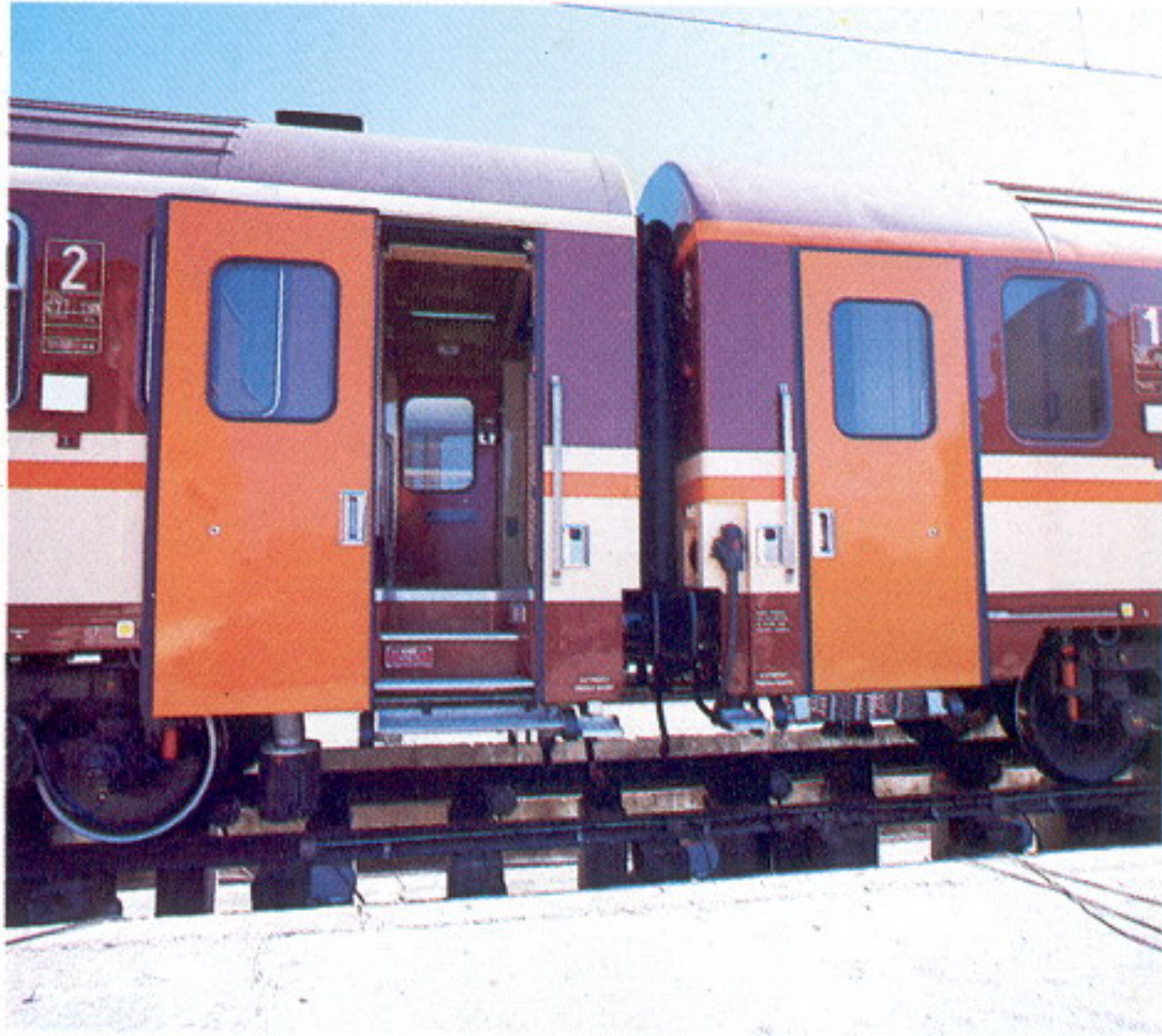
Puertas de acceso encajables-deslizantes con apertura y cierre automáticos.
