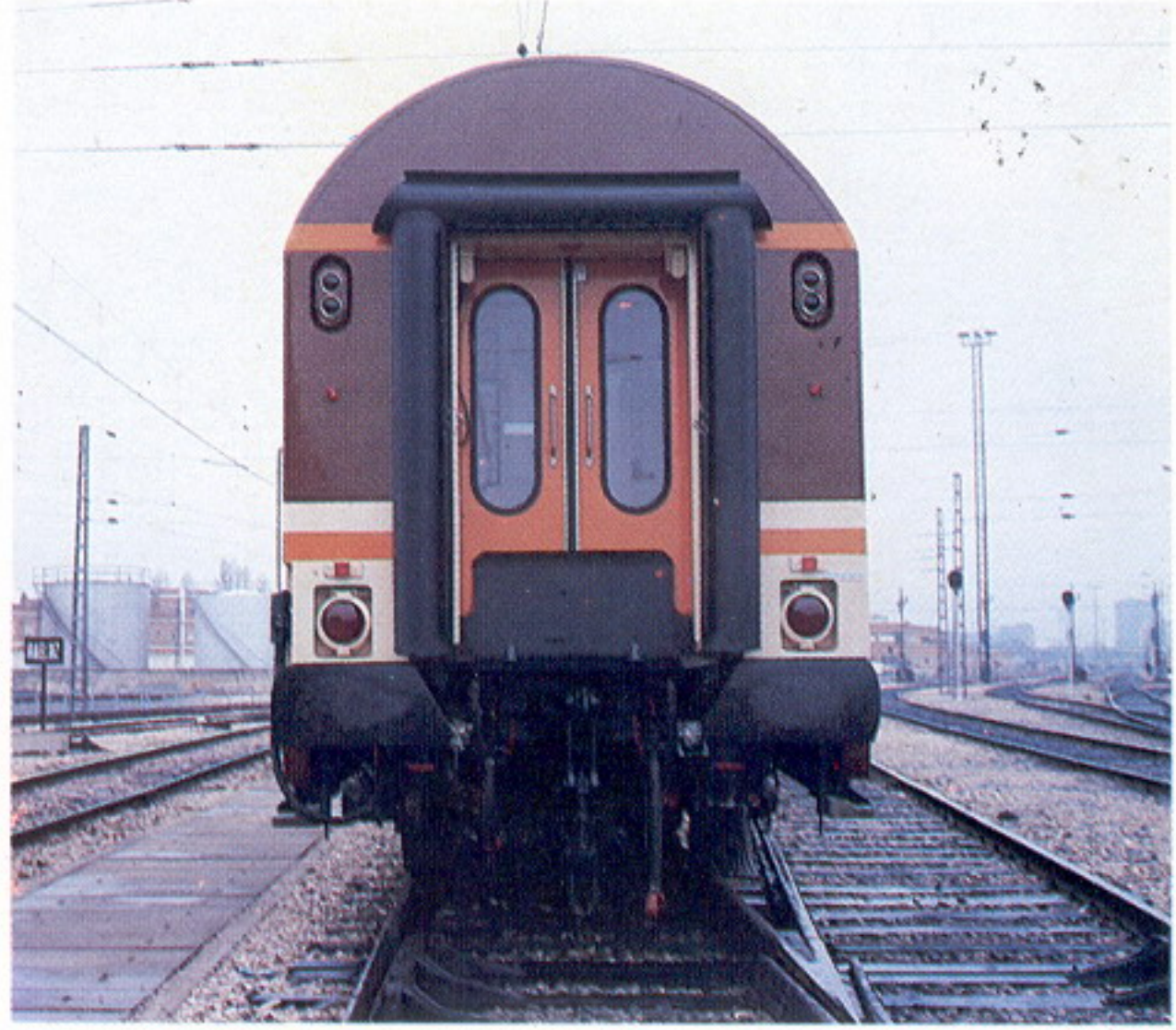
Testero del coche con puerta de intercurrención de apertura automática.
