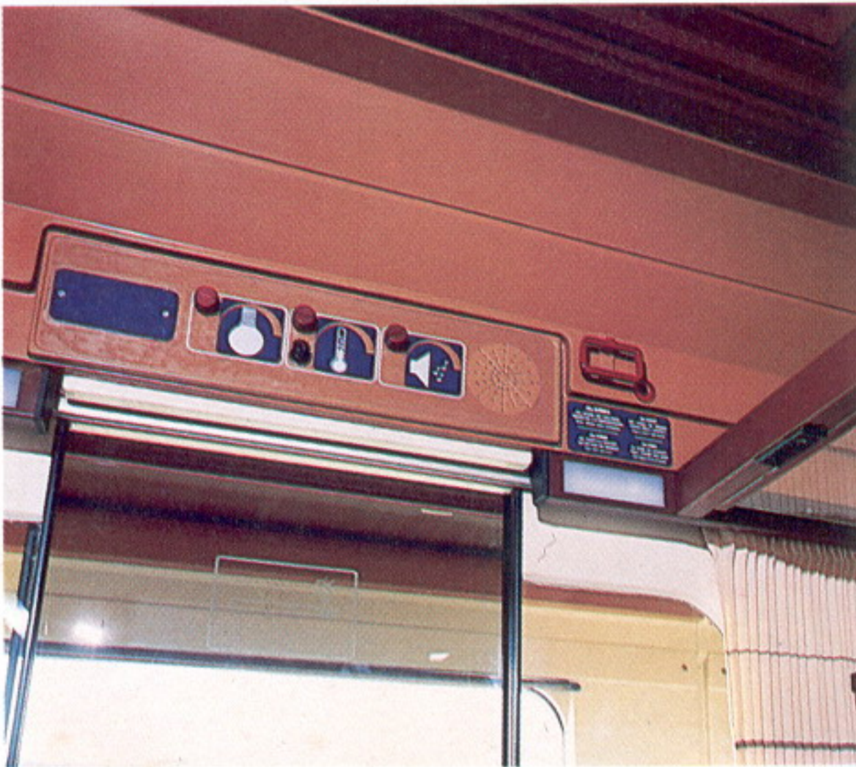
Luz de penumbra, pictogramas de alumbrado, aire acondicionado, sonorización y empuñadura de freno de alarma.
