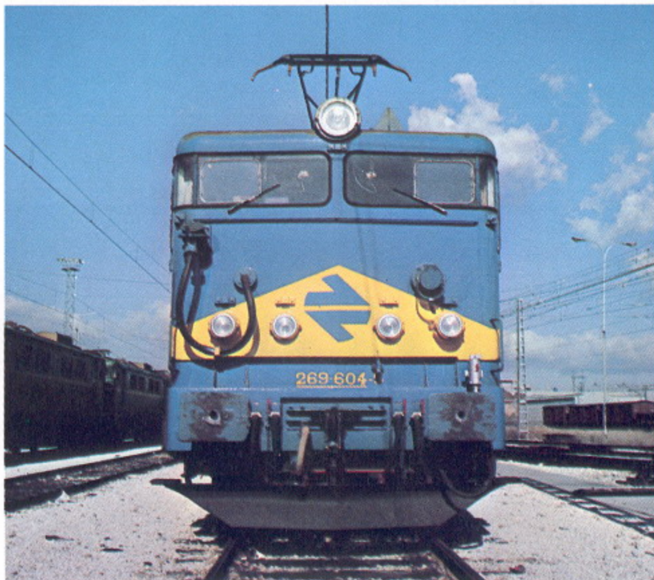
Subserie 269-601/604, para 160 km/h, equipo eléctrico "Chopper" corriente alterna para servicios auxiliares.
