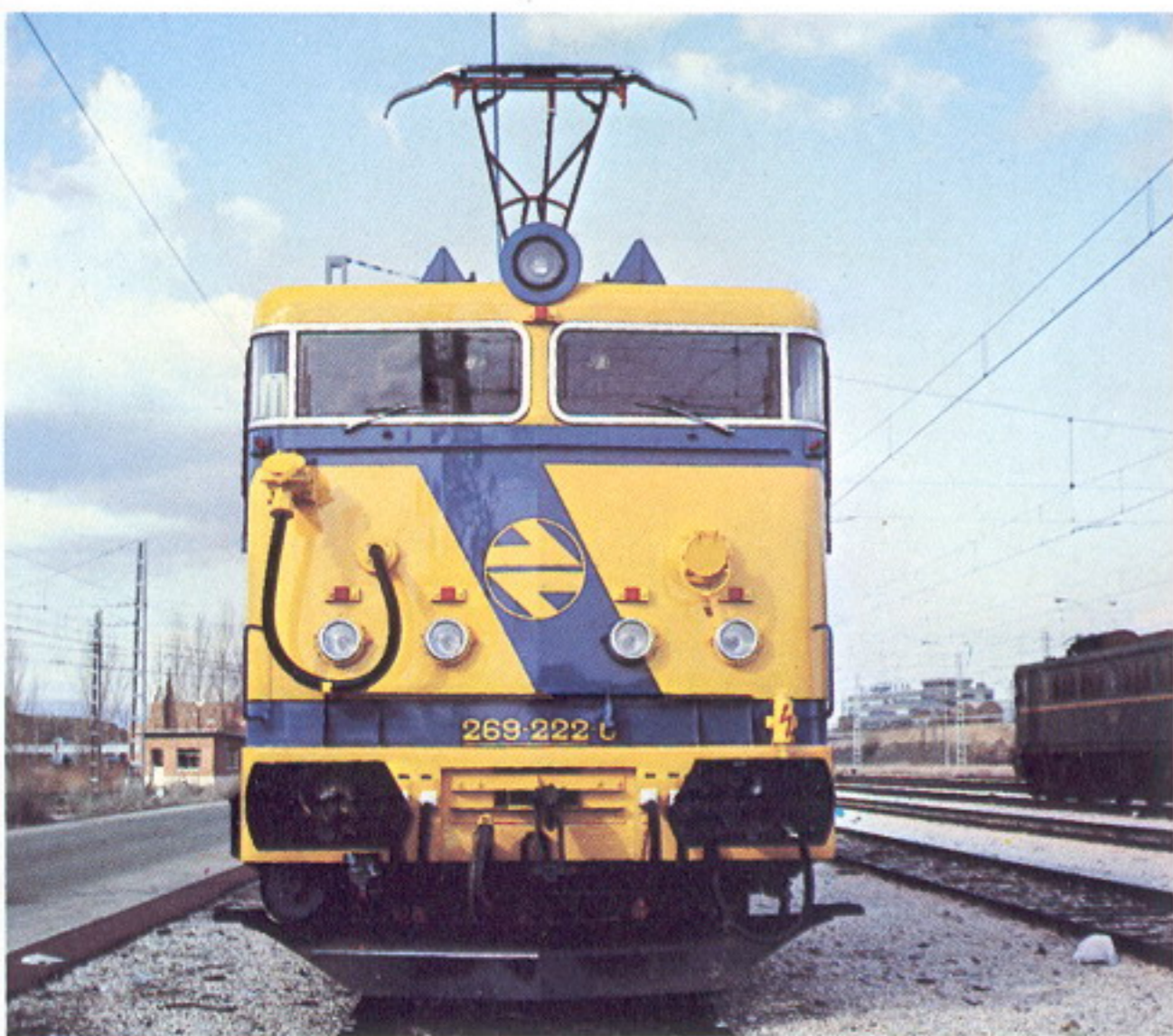
Subserie 269-222/331 para 160/100 km/h, equipo eléctrico convencional, corriente alterna para servicios auxiliares.
