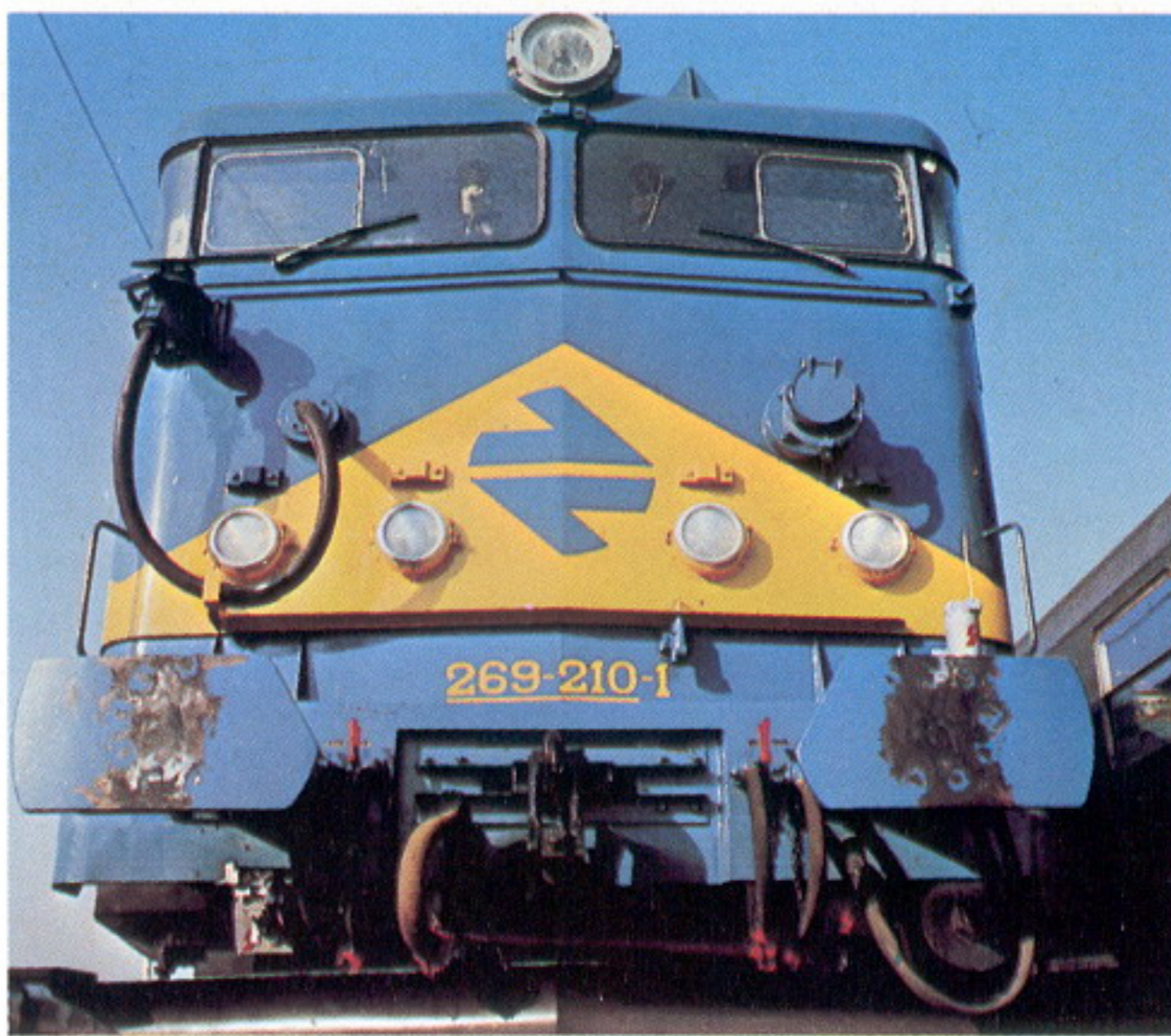
Subserie 269-201/221, para 160/100 km/h, equipo eléctrico convencional, corriente alterna para servicios auxiliares.
