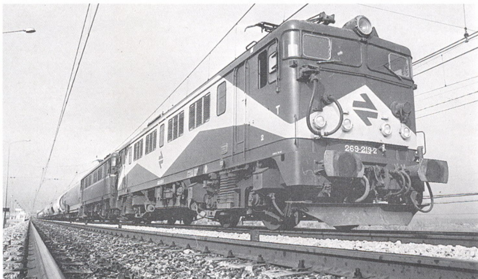
Doble tracción de locomotoras 269 de diferentes subseries para un tren de cisternas.
