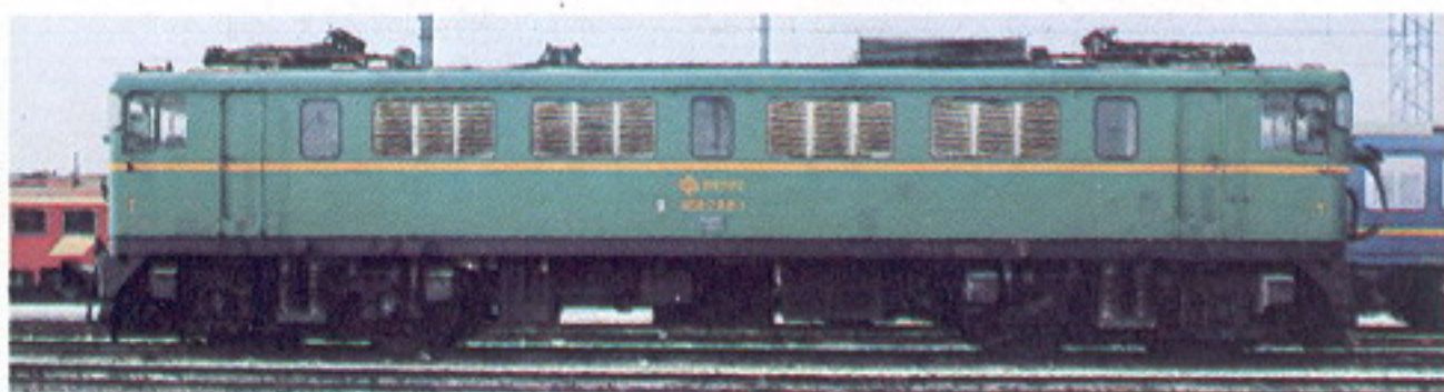
Subserie 269-222/331 para 160/100 km/h, equipo eléctrico convencional, corriente alterna para servicios auxiliares.
