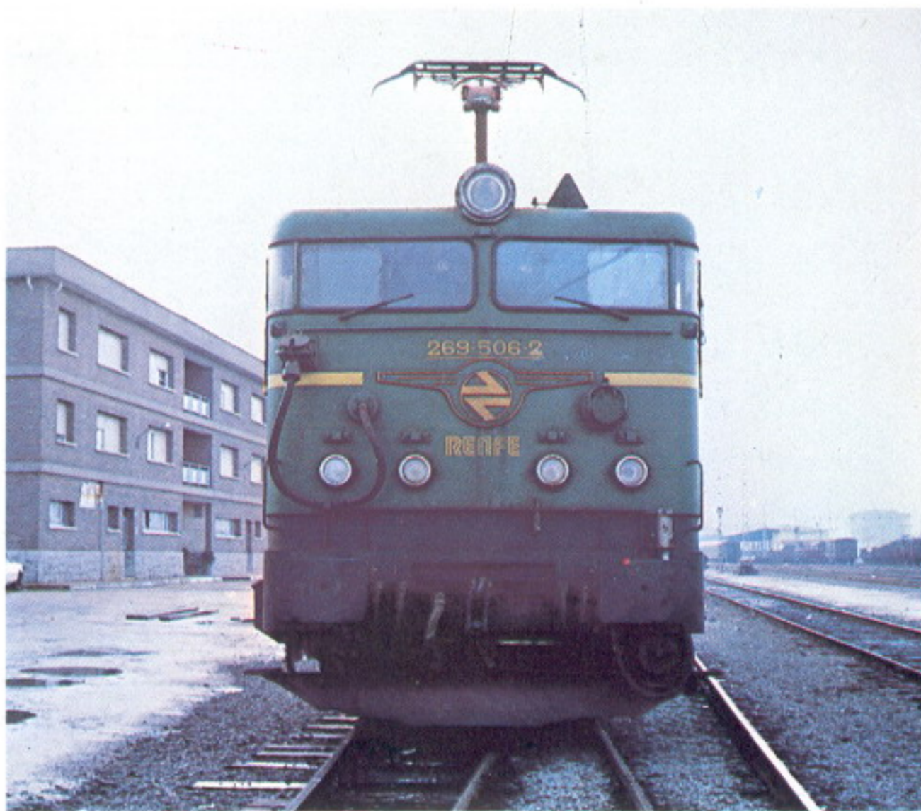
Subserie 269-501/522, para 160/90 km/h, equipo eléctrico convencional, corriente continua para servicios auxiliares.
