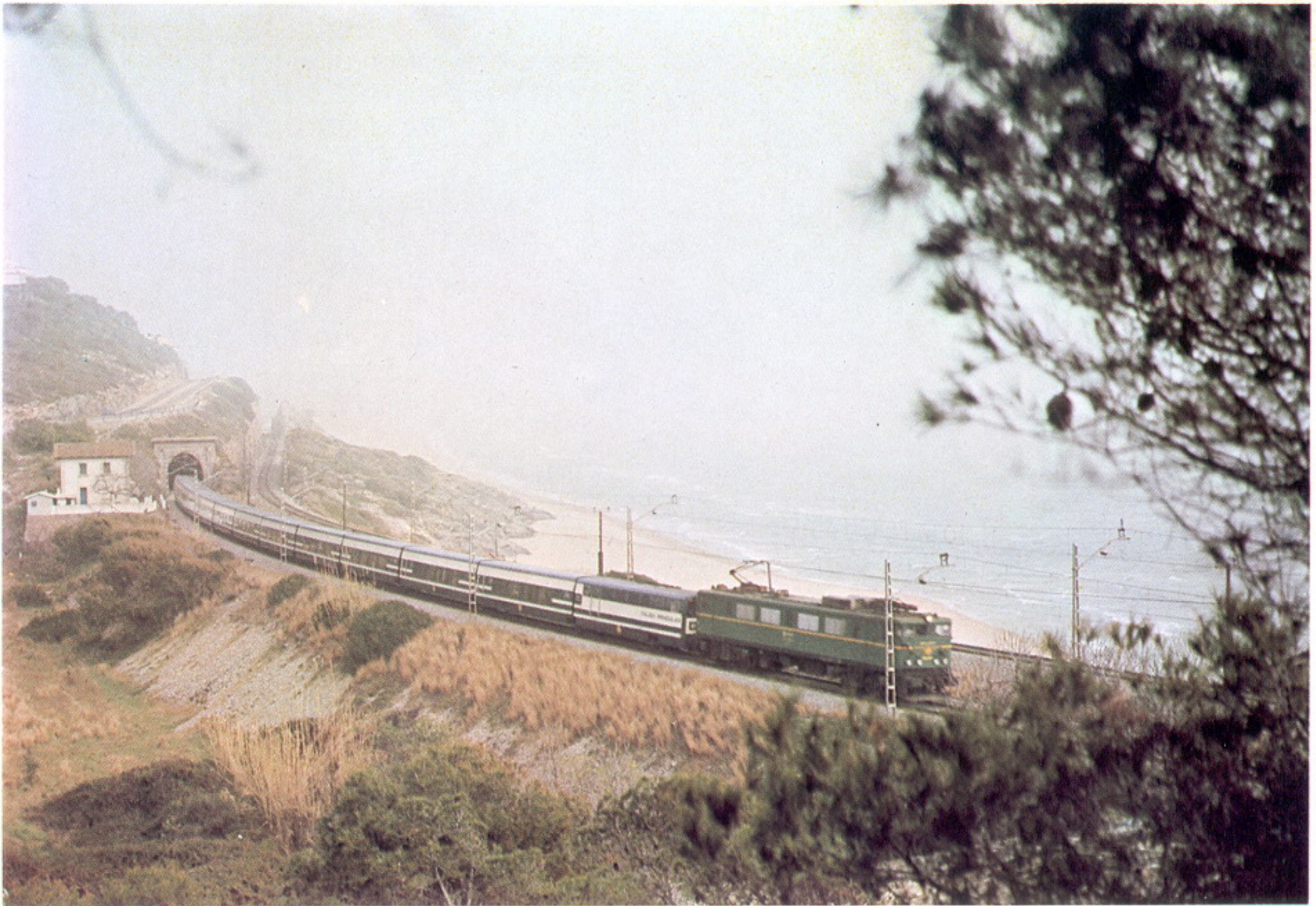
Las locomotoras 269 remolcan los trenes Talgo en líneas electrificadas.
