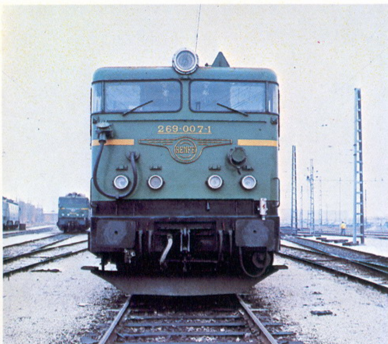
Subserie 269-001/108 para 140/80 km/h, equipo eléctrico convencional, corriente continua para servicios auxiliares.
