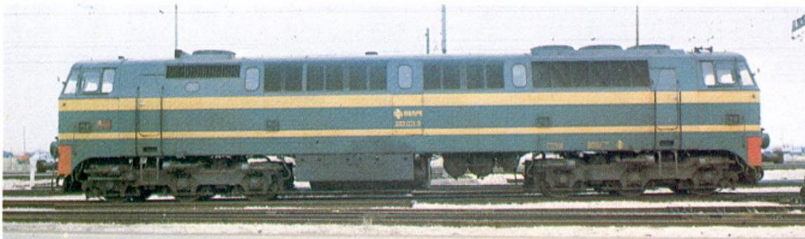
A la izquierda, vista lateral de la locomotora 333. Como se puede observar, se trata de una locomotora tipo Cócó.
