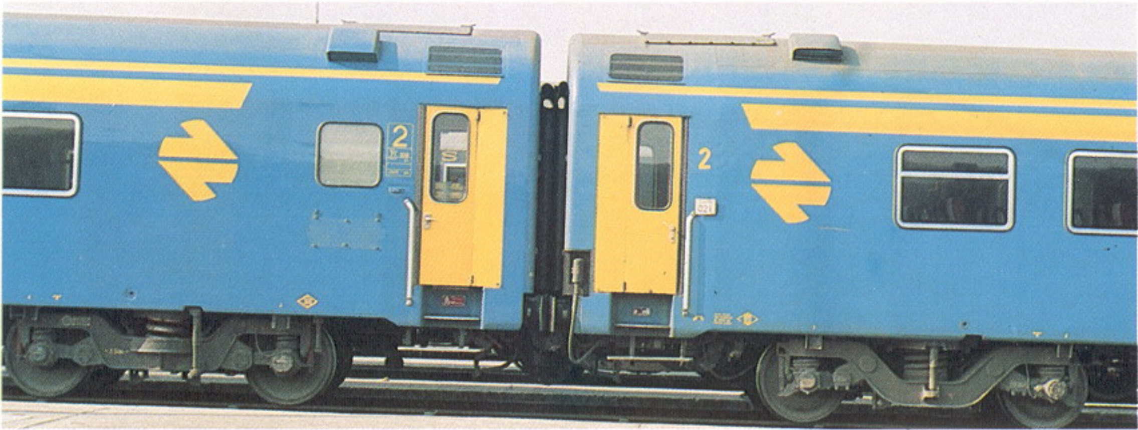
Como se observa en la fotografía los coches pueden ir montados tanto sobre bogies Fiat 80SL (a la derecha) como GC1 (a la izquierda).
