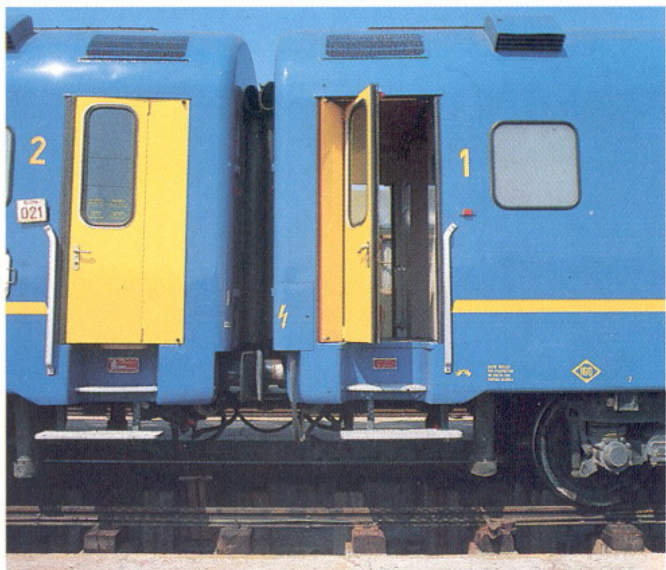
Las puertas de acceso son plegables y se cierran automáticamente.
