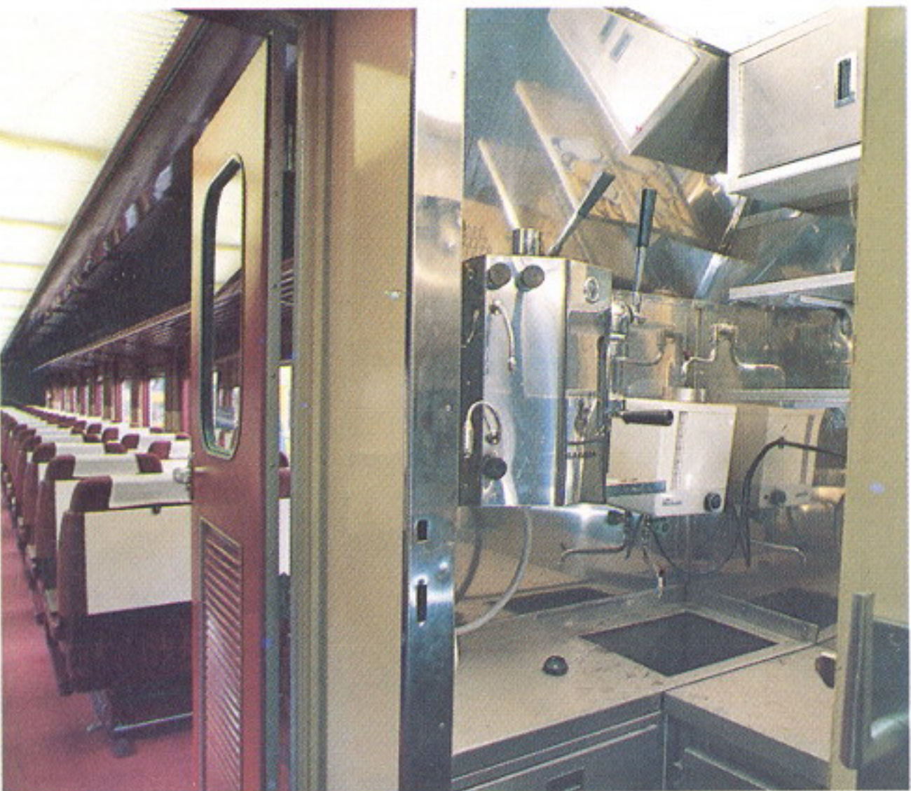
Los coches RRR9900 tienen cocina de gas, frigorífico, calentador de agua, horno, plancha y cafeteras.
