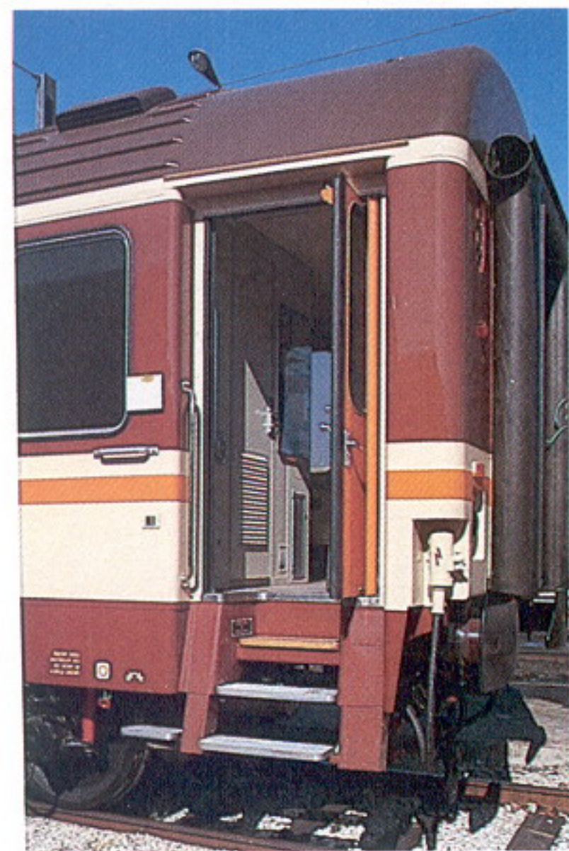
Puerta de acceso plegable pivotante con tres posiciones diferentes en combinación con peldaño inferior abatible.
