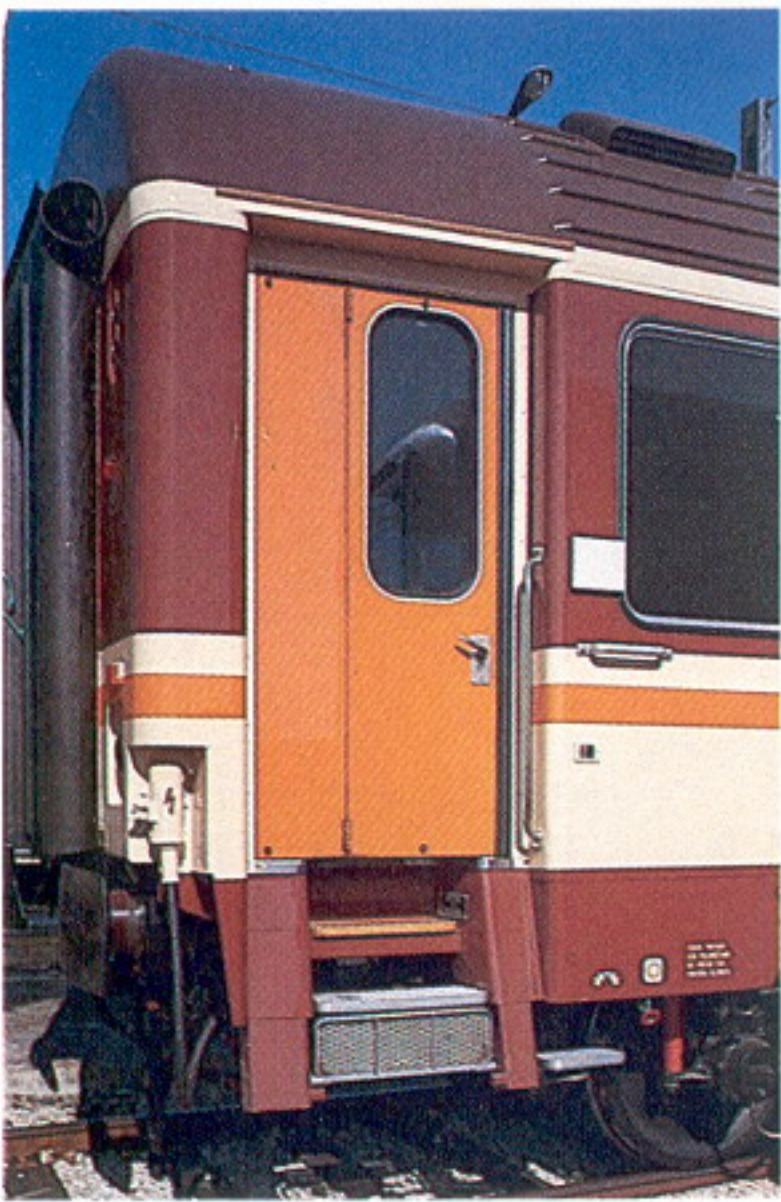
Puerta de acceso plegable pivotante con tres posiciones diferentes en combinación con peldaño inferior abatible.
