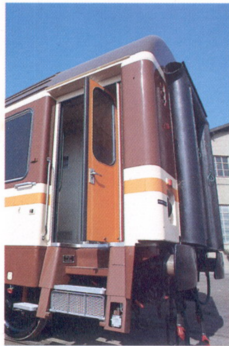
Puerta de acceso plegable pivotante con tres posiciones diferentes en combinación con peldaño inferior abatible.
