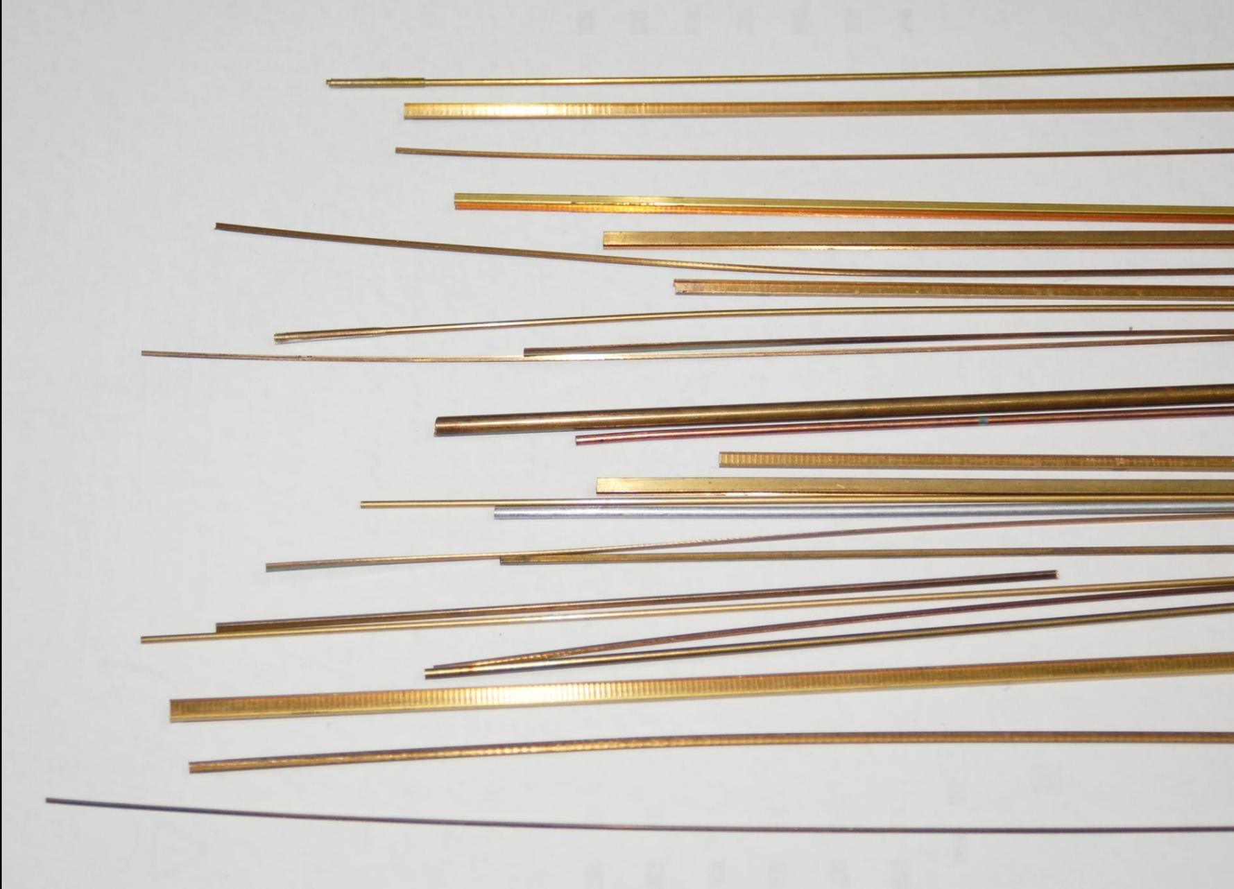
Perfiles y varillas de latón en diferentes secciones y diámetros
