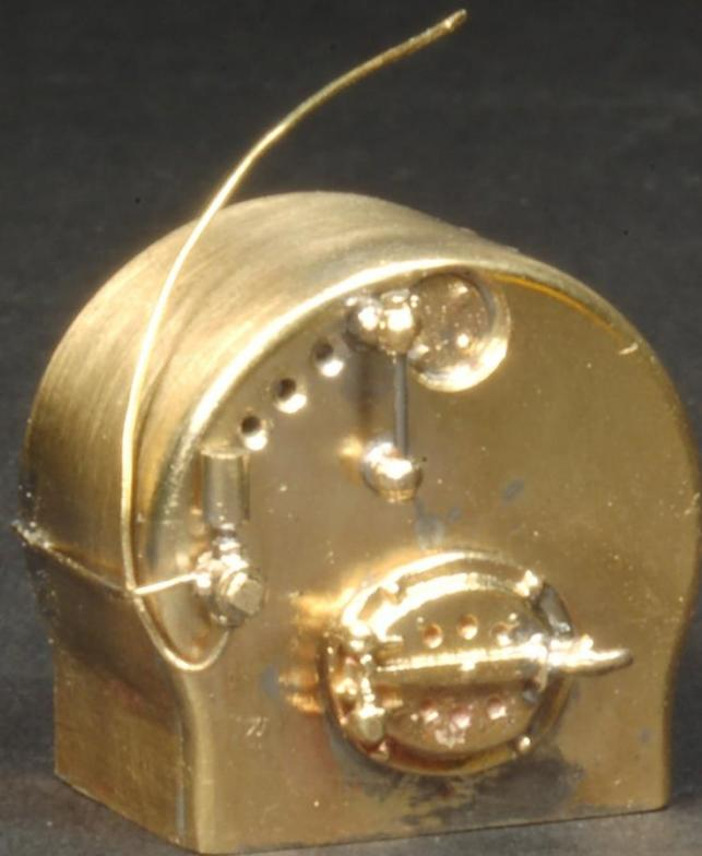
Y la construcción del frontal del hogar, que se realizará con la iluminación interior de la cabina
