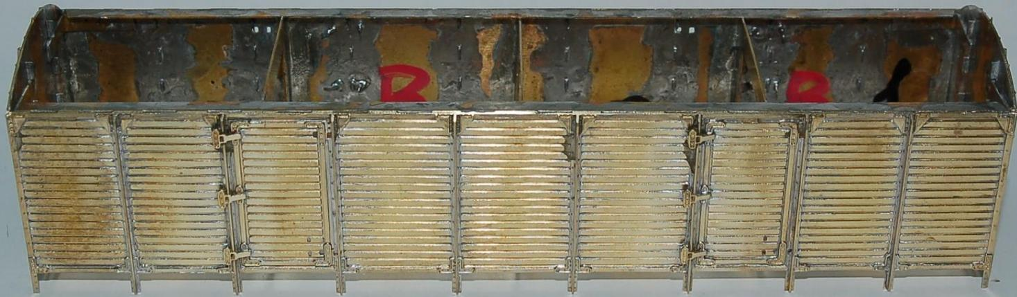
La caja del vagón acabada, solo a falta de soldar el techo.
