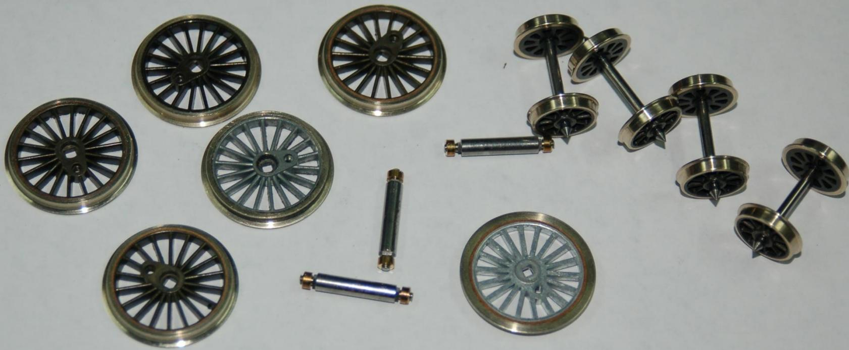
Ruedas y ejes específicos para equipos de montaje de locomotoras: Romford
