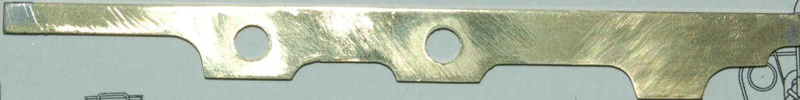
Perforar los orificios de los ejes y colocar cojinetes
