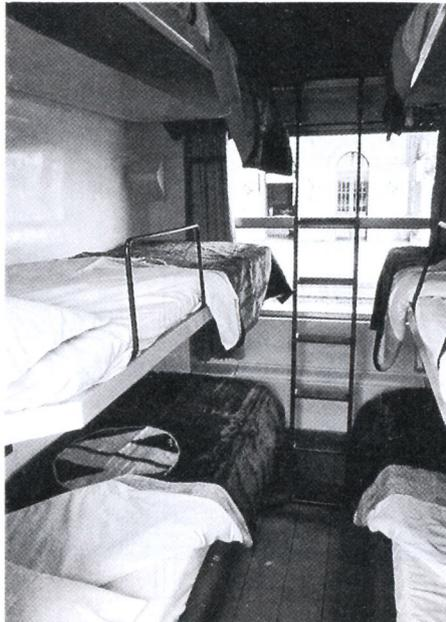
Vista en disposición nocturna de sendos departamentos de los coches literas BBL 9600 (izquierda) y BBL-10800 (derecha). El primero está revestido con paneles de estratificado, mientras que el segundo adopta paneles moldeados de poliéster (Fotos MACOSA y RENFE).
