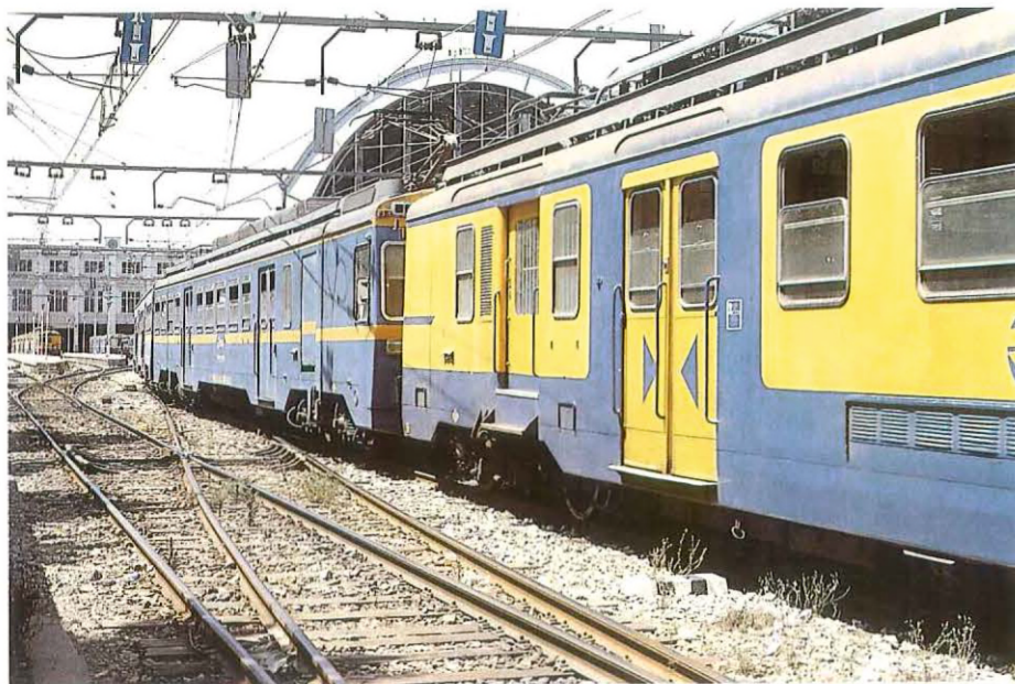
Excepcionalmente y por avería eléctrica de la UT suiza, fue acoplada mecánicamente mediante el enganche Scharfenberg a una UT 440 la cual la remolcó hasta la estación de França. Foto E. Ramírez, año 1986.
