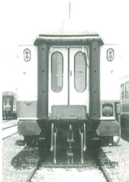
Los tres tipos de puertas de intercomunicación de los coches modernizados: a la izquierda la de un coche camas WL26x 7100; en el centro la de todos los coches de las series 11000 y 12000; y a la derecha la de un coche B111 16200. (Fotos: Luis Rentero Corral, 1995).
