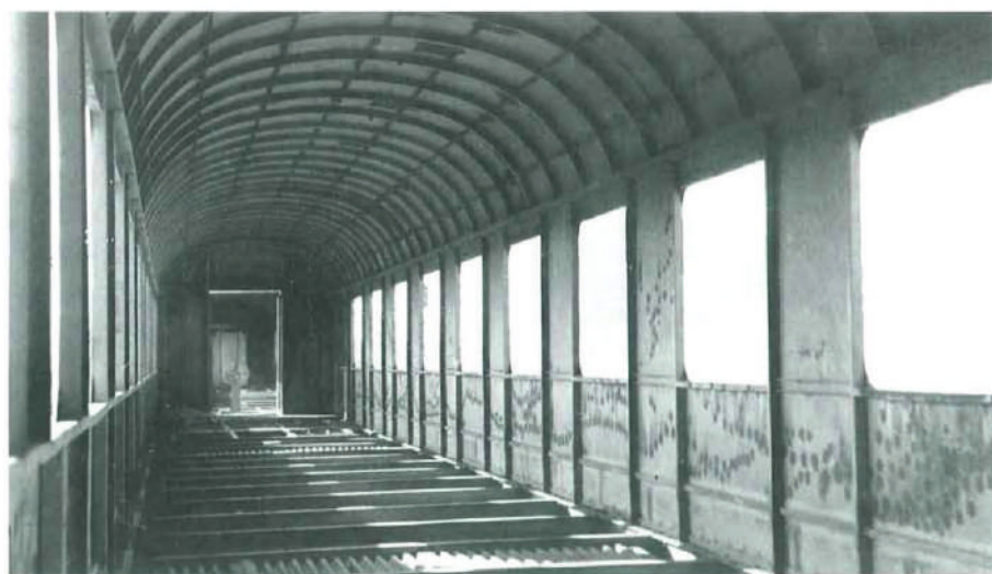
Interior de la caja del coche AA 8081, tal y como quedaban los coches al desmontarse la totalidad de sus elementos como primer paso de la modernización. (Foto: Juan Martín Padilla, Málaga-Los Prados, 16.02.1995).
