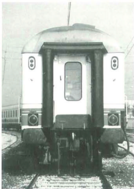
Los tres tipos de puertas de intercomunicación de los coches modernizados: a la izquierda la de un coche camas WL26x 7100; en el centro la de todos los coches de las series 11000 y 12000; y a la derecha la de un coche B111 16200. (Fotos: Luis Rentero Corral, 1995).
