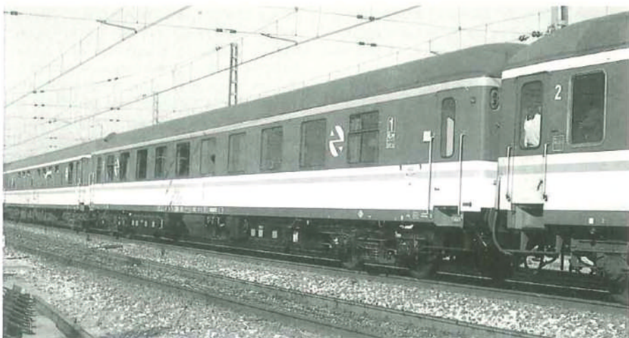
El coche de primera clase tipo salón A12t 12004, procedente de la transformación del AA 8056, circulando en un tren especial de A Coruña y Vigo a Madrid. (Foto: Joan Acón, Medina del Campo, 31.03.1991).
